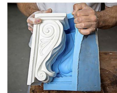
Eine schnelle und doch exakte Arbeit: Nur zwanzig Minuten bleiben dem Experten, um den flüssigen Gips zu verarbeiten – dann setzt sich dieser ab.
