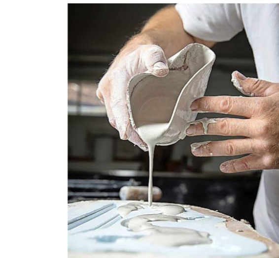
Eine Technik von vielen: Jäggi giesst flüssigen Gips in eine von ihm erstellte Silikonform. Die Form ist der Abguss eines Originals.
