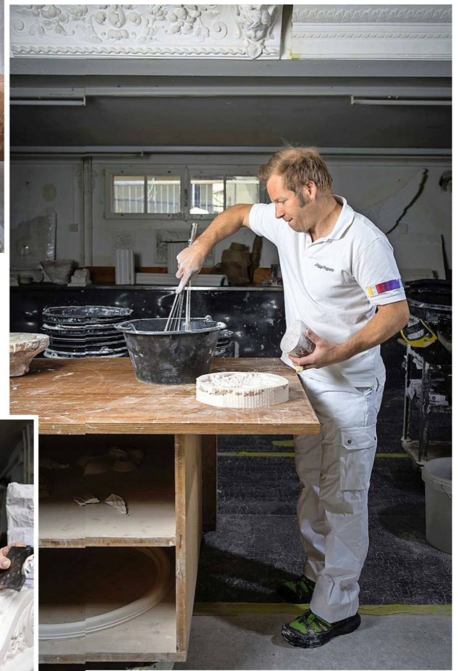
Eine Technik von vielen: Jäggi giesst flüssigen Gips in eine von ihm erstellte Silikonform. Die Form ist der Abguss eines Originals.
